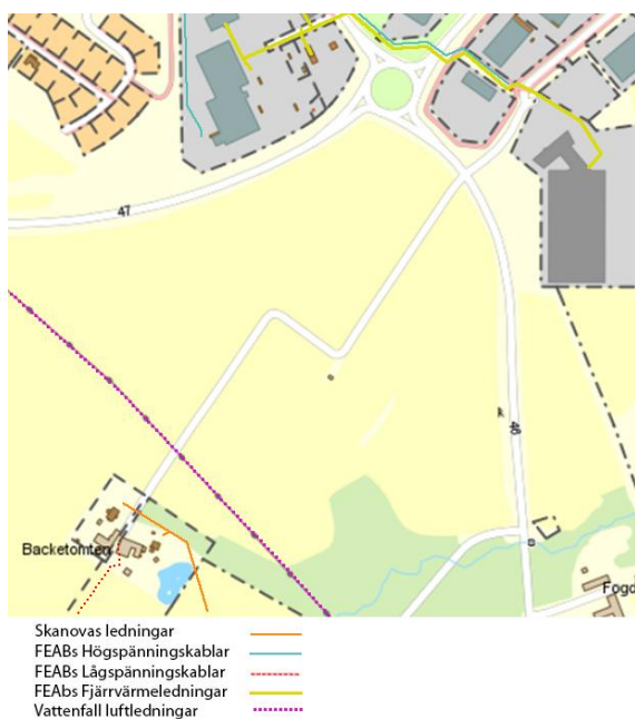
Figur 7 visar de befintliga ledningarna inom och kring planområdet
